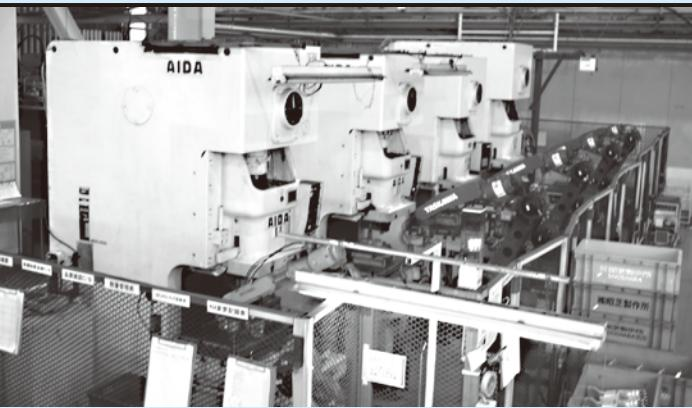
▲NC1-110トン自動化ロボットライン
