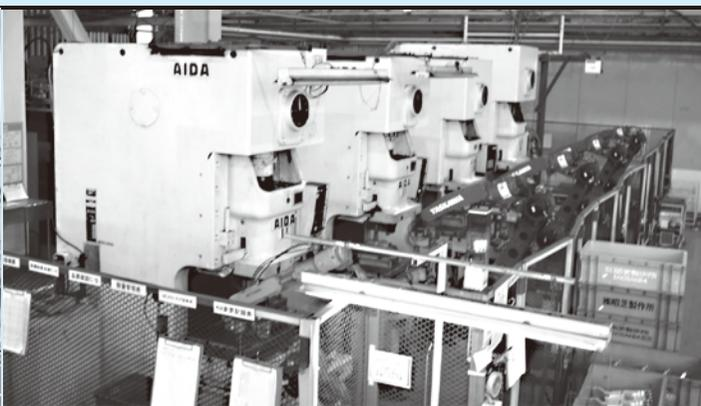
▲ NC1-110トン自動化ロボットライン
