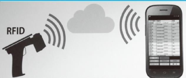
▲金型ごとにRFIDタグを装着しスピーディなピッキング、棚卸を実現した金型管理システム（自社開発）
