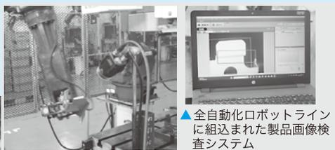
▲全自動化ロボットラインに組込まれた製品画像検査システム
